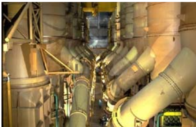
شکل (۴۸) چند سلول از کارخانه غنی سازی اورانیم با روش نفوذ از جدارخلل و فرج دار.
